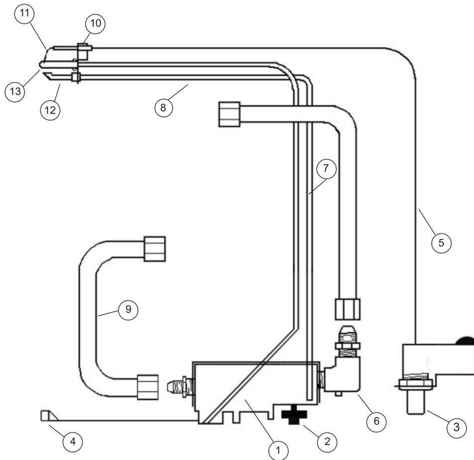
Le réglage de la flamme pilote se trouve sur le dessus de la vanne. Localisez le réglage de la veilleuse à la main droite supérieure de la vanne près de la connexion du tube pilote.
